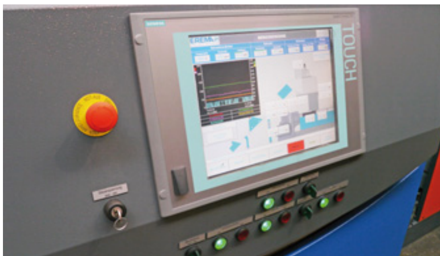
Bild 3. Über einen Software-Schalter, der in die Bedienoberfläche des Industrie-PC der Anlage integriert ist, lässt sich die sichere Teleservice-Verbindung auf- und abbauen
