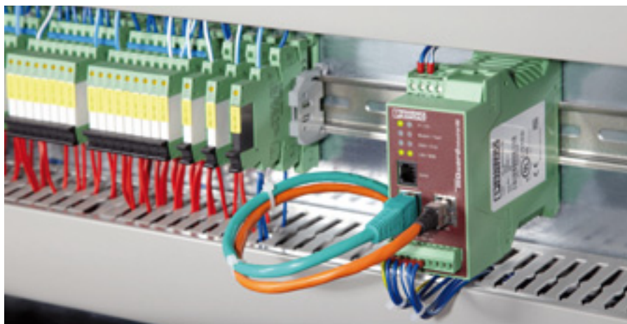
Bild 2. Erema verbaut in seinen Recycling-Maschinen die industrietauglichen Hutschienengeräte „FL MGuard“ von Phoenix Contact als sichere VPN-Router
