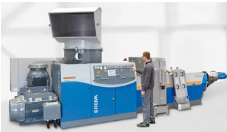
Bild 1. Aufgrund des patentierten Extruderkonzepts erfüllt die Kunststoff-Recycling-Anlage vom Typ „TVEplus“ die hohen Ansprüche an die Verarbeitung stark bedruckter und/oder verschmutzter respektive feuchter Kunststoffabfälle
