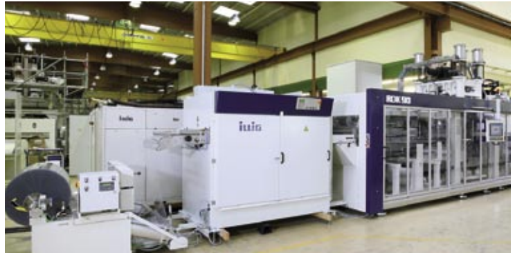
Thermoformmaschine RDK 90 von Illig, Rollenautomat für kombiniertes Formen und Stanzen: bequem überwacht per VPN
