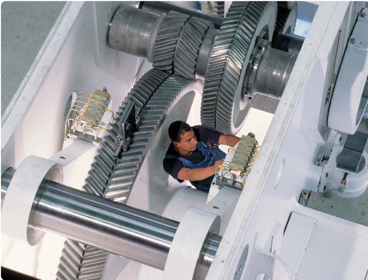
Bild 1: Ein Monteur bei der Montage einer Großpresse.
