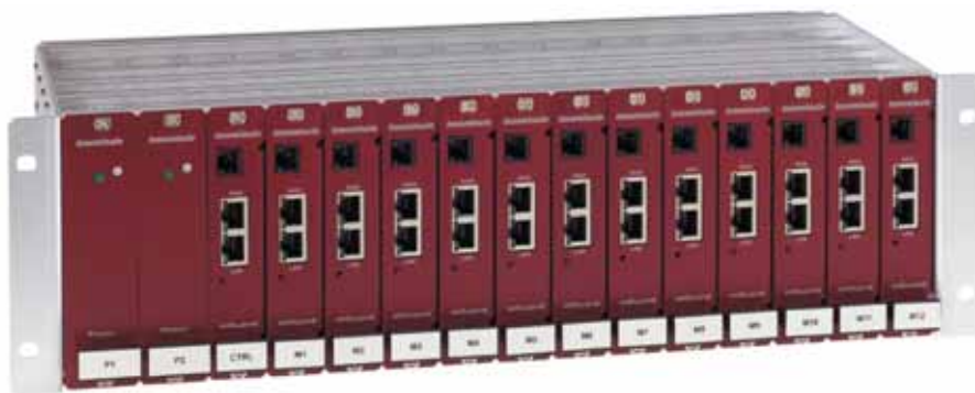
Innominat mGuard bladePack zur Absicherung einer großen Zahl verschlüsselter Übertragungskanäle
