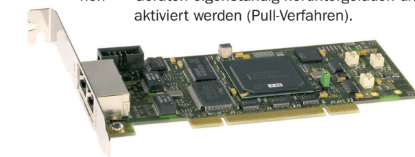
Beispiele von Mguard-Produktvarianten zur Montage auf DIN-Hutschienen und im integrierbaren PCI-Kartenformat
