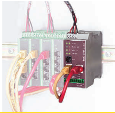
Bild 3: Der Innominate mGuard industrial RS im Einsatz als Security Router mit 1:1 NAT.
